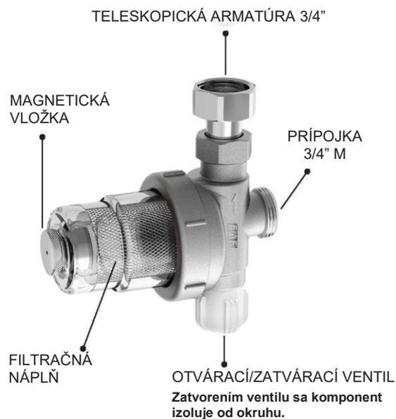
Voda vstupujúca do filtra odlučovača nečistôt vstupuje do zbernej nádoby, kde sú častice nečistôt filtrované a blokované pred vstupom do kotla. Magnetická vložka ponúka ďalšiu výhodu pri odstraňovaní železných častíc prítomných predovšetkým v starých systémoch, ktoré podliehajú korózii.
